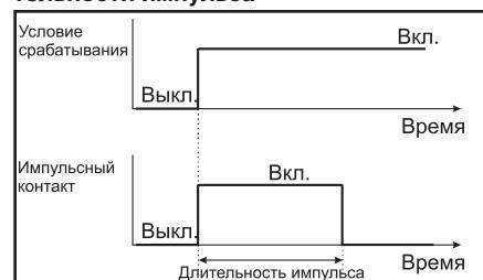
**Импульсный контакт****Условие срабатывания короче длительности импульса**
