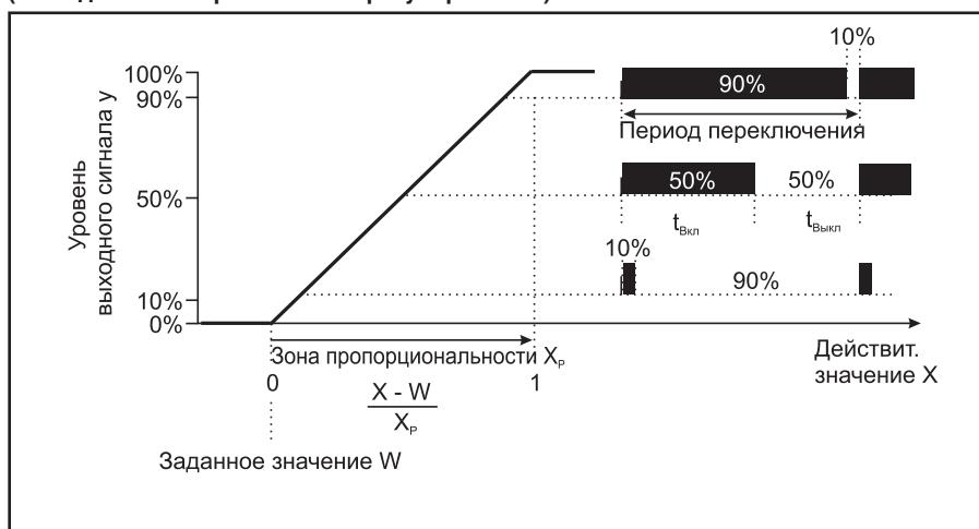
Если действительное значение превышает заданное значение, П-регулятор регулирует пропорционально величине отклонения. При превышении зоны пропорциональности регулятор работает с уровнем выходного сигнала 100 %.
