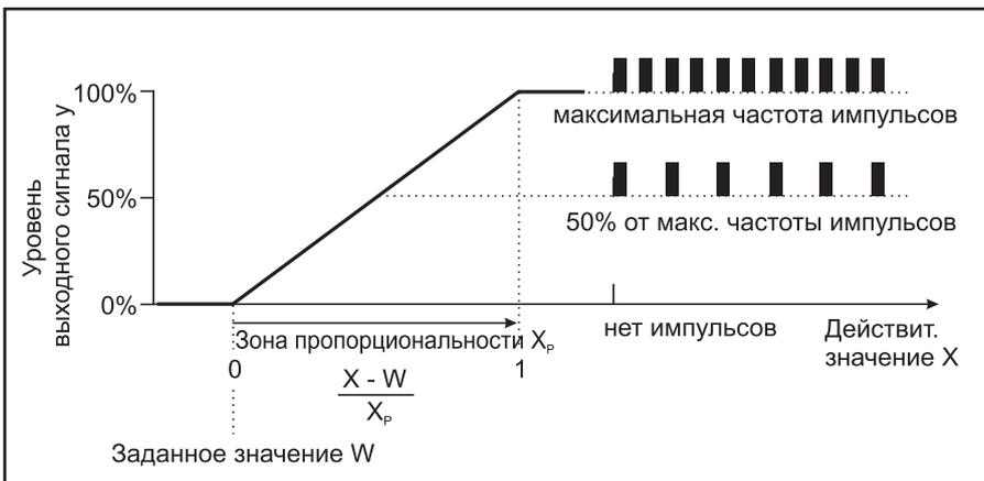
Если действительное значение превышает заданное значение, П-регулятор регулирует пропорционально величине отклонения. При превышении зоны пропорциональности регулятор работает с уровнем выходного сигнала 100 % (максимальная скорость переключения).
