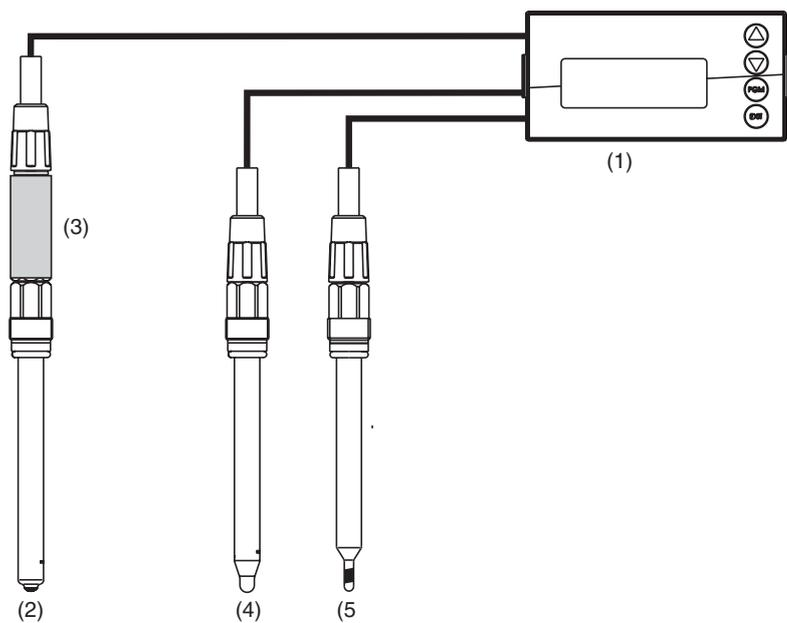
**Измерение величины pH (с компенсацией по температуре) и измерение расхода**
